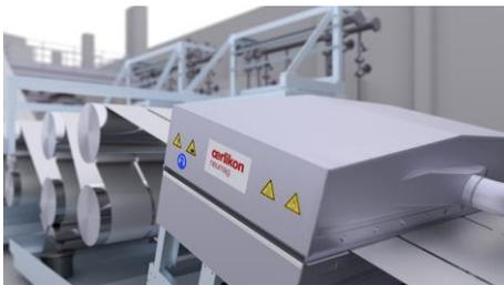
Innovative Streckpunktauslösung mithilfe eines Dampfvorhangs für verbesserte Faserqualitäten.
